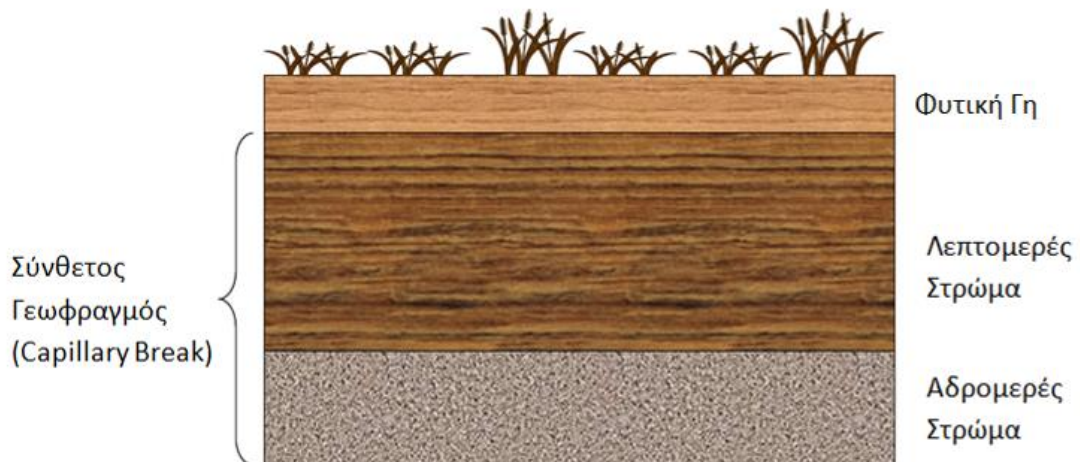
Σχήμα 6.5-1. Χαρακτηριστική σύνθεση ενός συστήματος στεγανοποιητικού επικαλύμματος εδαφών με τη χρήση της μεθόδου σύνθετου γεωφραγμού (Capillary Break)
