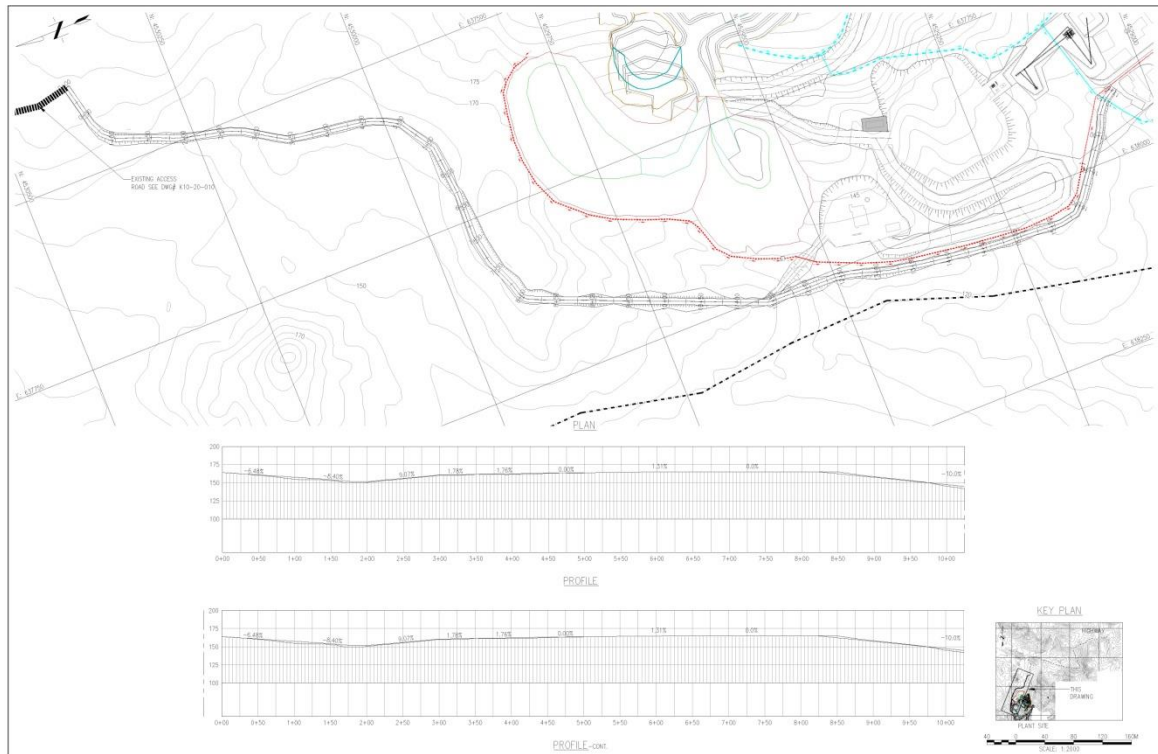
Σχήμα 5.15-1. Χαρακτηριστικές κατόψεις και μηκοτομές του κύριου δρόμου πρόσβασης στο εργοστάσιο επεξεργασίας
